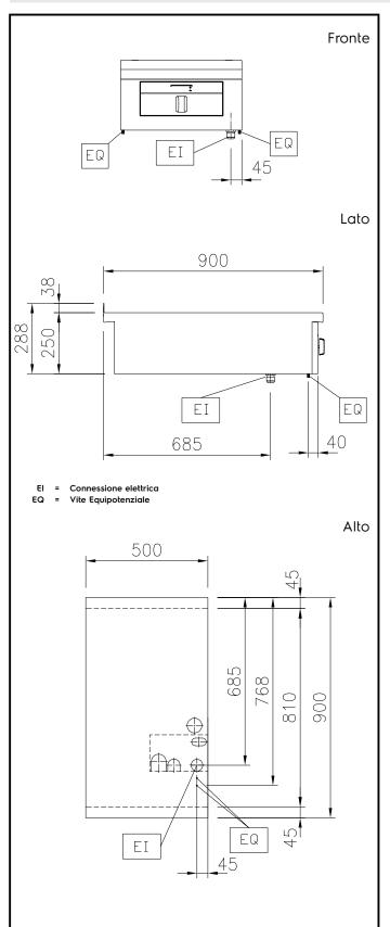
**Elettrico** Tensione di alimentazione: 400 V/3N ph/50/60 Hz Watt totali: 5 kW Informazioni chiave Dimensioni esterne, larghezza: 500 mm Dimensioni esterne, profondità: 900 mm Dimensioni esterne, altezza: 250 mm Peso netto: 18 kg Potenza piastre posteriori: 5 - kW Dimensioni piastre posteriori: Ø 300 Dimensioni top induzione 500 mm (larghezza): Dimensioni top induzione (profondità): 900 mm
